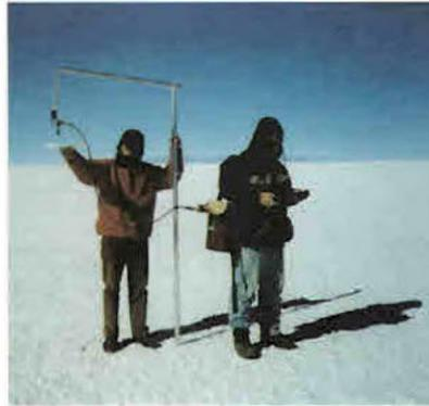
Fig. 7.12 Configuração adotada no uso do radiômetro Li-cor LI-1800
