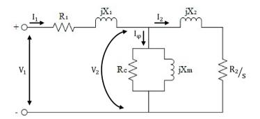
Figura 1 - Circuito equivalente monofásico de um MIT.
