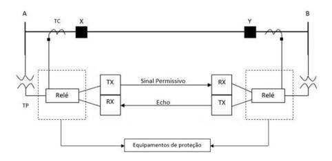
Figura 1. Esquema Permissive Overreaching Transfer Trip (POTT) com lógica Echo.
