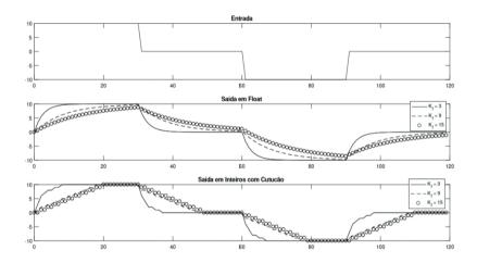
Figura 11. Resposta do filtro com Soma Triangular para valores diferentes de  $K_i$  com entrada retangular
