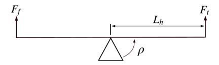
Figura 5 – Diagrama de corpo livre do eixo de arfagem.
