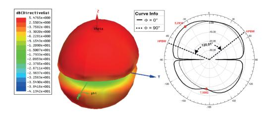
Figura 8 – Diagrama de irradiação 2D e 3D para o arranjo de antenas AM2 mini.
