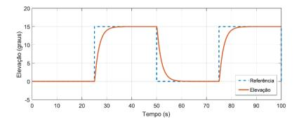
Figura 11 – Resposta ao degrau de aplicado ao ângulo de elevação do sistema simulado.
