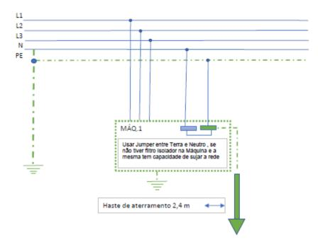
Figura 3: Sistema Sugerido pelo Autor – Próximo ao TN-C-S Fonte: Autor
