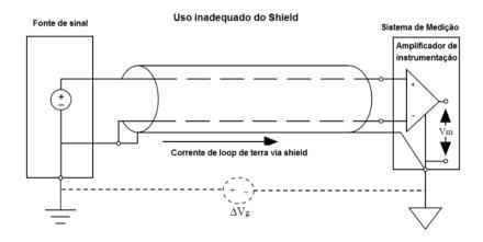
Figura 7: Uso inadequado do shield, aterramento em mais de um ponto Fonte: Smar Automação Industrial
