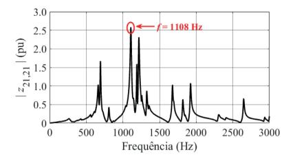
Fig. 2. Módulo da impedância própria da barra 21.
