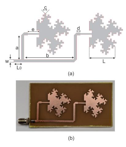
Figura 2 – Arranjo de antenas de microfita quase-fractal proposto: (a) Estrutura do arranjo com suas dimensões em milímetros; (b) Protótipo fabricado.
