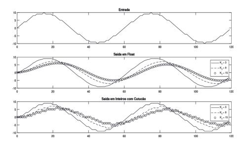
Figura 13. Resposta do filtro com Soma Triangular para valores diferentes de  $K_i$  com entrada senoidal normalizado por  $K_i$
