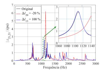
Fig. 4. Respostas em frequência do módulo de z<sub>21,21</sub>, considerando o sistema original e com alterações nos comprimentos das LTs 20 e 13.
