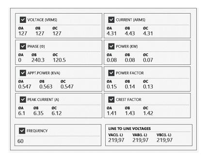
Figura 4 – Interface de leitura de dados do software da fonte programável.
