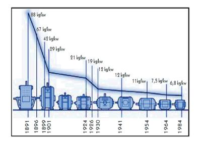
Figura 2 - Evolução dos motores de indução.
