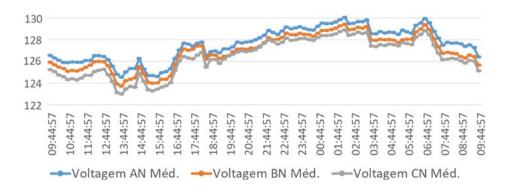
Figura 20 - Tensões de fase nos terminais do Tranformador T1
