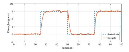
Figura 12 – Resposta ao degrau de aplicado ao ângulo de elevação do sistema real.
