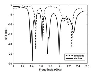
Figura 5 – Resultado comparativo em simulação e medição para o arranjo AM2.
