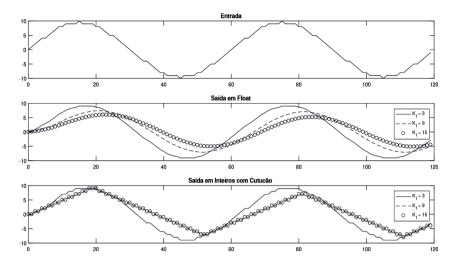
Figura 12. Resposta do filtro com Soma Triangular para valores diferentes de  $K_i$  com entrada senoidal
