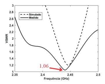
Figura 7 – Resultado medido e simulado de VSWR para o arranjo AM2 mini.
