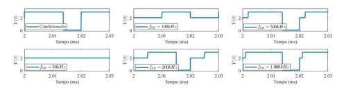
Figura 12: Comportamento do sinal amostrado em função da variação de f<sub>sa</sub>.
