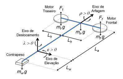
Figura 3 – Diagrama de corpo livre do sistema completo.
