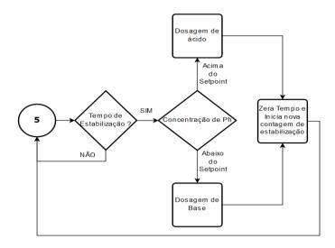
Figura 9 – Correção da concentração de pH Fonte: Próprio Autor, 2019
