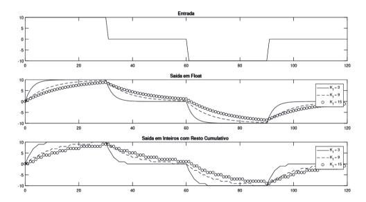
Figura 15. Resposta do filtro com Resto Acumulativo para valores diferentes de  $K_i$  com entrada retangular
