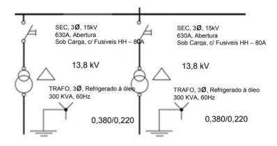
Figura 3 - Diagrama unifilar com Transformadores T3 e T4
