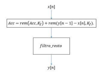
Figura 17. Fluxograma Algoritmo Resto Acumulativo
