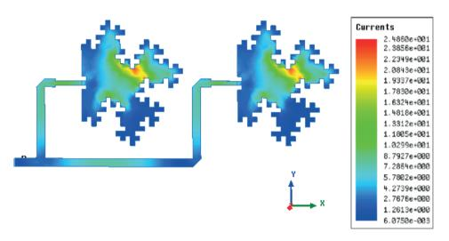
Figura 9 – Distribuição de corrente no arranjo AM2 mini proposto.
