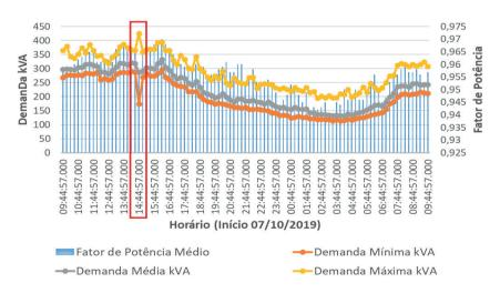
Figura 8 - Potência aparente do Transformador T1 – 1000KVA Fonte: Dos autores, 2020
