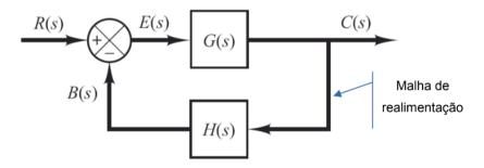
Figura 1-Diagrama de blocos -sistema de controle de malha fechada Fonte: Ogata, 2010
