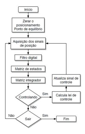
Figura 8 – Fluxograma do algoritmo implementado no protótipo.
