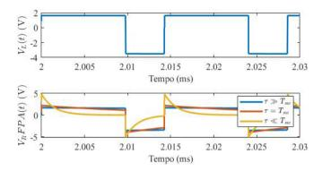
Figura 6: Resposta do filtro passa alta em função da variação de τ.
