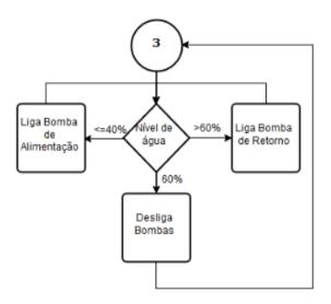
Figura 6 – Alimentação e controle de nível de água Fonte: Próprio Autor. 2019
