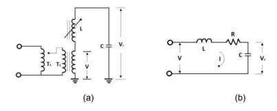
Fig. 2 – (a) Esquema simplificado de um Teste Série b) Circuito Equivalente da FR.
