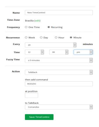
Figura 8 – Interface *Time-Control* no *ThingSpeak*Fonte: Próprio Autor, 2019
