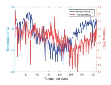
Figura 2 - Máximas diárias de temperatura e potência.
