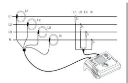
Figura 4 - Conexão medidor em rede trifásica Y
