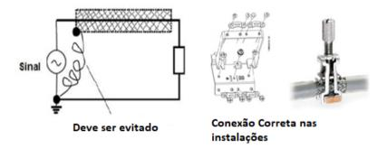
Figura 5: Clamp EMC – para ligação do Shield Fonte: ICOTEk SMART CABLE MANAGEMENT
