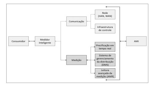
Fig. 2 Estrutura da solução AMI.
