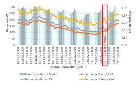
Figura 12 - Potência aparente do Transformador T2 – 1000KVA Fonte: Dos autores, 2020
