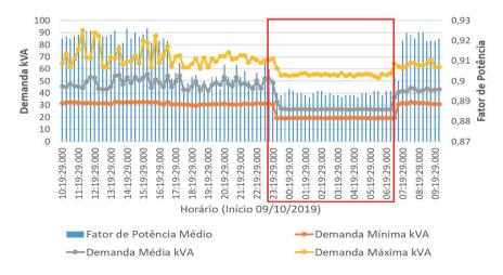
Figura 16 - Potência aparente do Tranformador T3 – 300KVA Fonte: Dos autores, 2020
