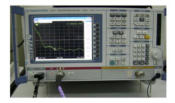
Figura 4 – Fotografia do analisador de rede utilizado na parte experimental e captura dos parâmetros de espalhamento.
