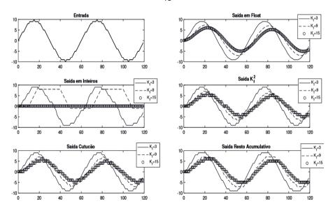
Figura 19. Resposta de todos os métodos para uma entrada senoidal para  $K_i = 3$ ,  $K_i = 9$ ,  $K_i = 15$
