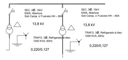
Figura 2 - Diagrama unifilar com Transformadores T1 e T2
