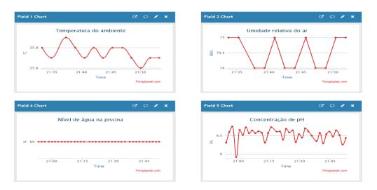
Figura 3 – Representação gráfica das leituras dos sensores Fonte: Próprio Autor, 2019
