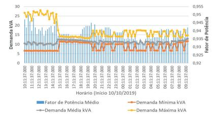
Figura 18 - Potência aparente do Transformador T4 - 300KVA
