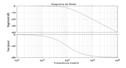
Figura 2. Resposta em frequência do filtro single-pole passa-baixa
