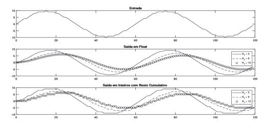
Figura 16. Resposta do filtro com Resto Acumulativo para valores diferentes de  $K_r$ com entrada senoidal
