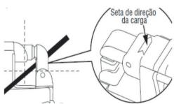
Figura 5 - Conexão entre sonda de corrente e linha
