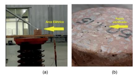
Fig. 6 – Testes de FAI na FR em prova de concreto. a) Ocorrência de arco elétrico b)
