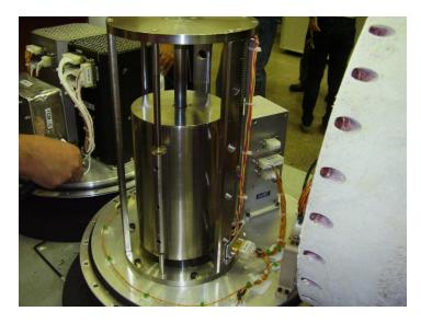
Figura 6 – Forno e a unidade de controle (ambos estão invertidos) após o resgate da carga útil.
