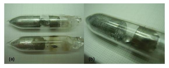
Figura 7 – (a) Amostras de PbTe (acima) e PbSn solidificadas em ambiente de microgravidade; (b) Detalhe da ampola com amostra de PbTe.
