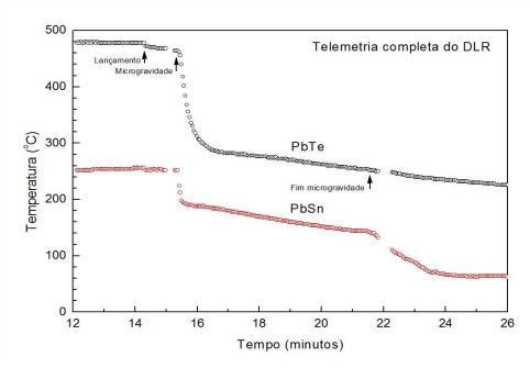
Figura 5 – Temperaturas dos termopares das amostras obtidos por telemetria.
