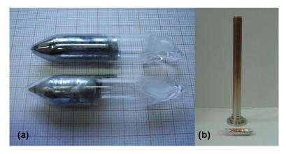
Figura 3 – (a) Ampolas de quartzo contendo as ligas de PbSn e PbTe; (b) Porta amostras de aço para proteção das ampolas de quartzo.
