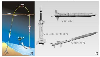
Figura 1 – (a) Esquema de um vôo parabólico do VS-30; (b) Foguetes de sondagem brasileiros para microgravidade.
