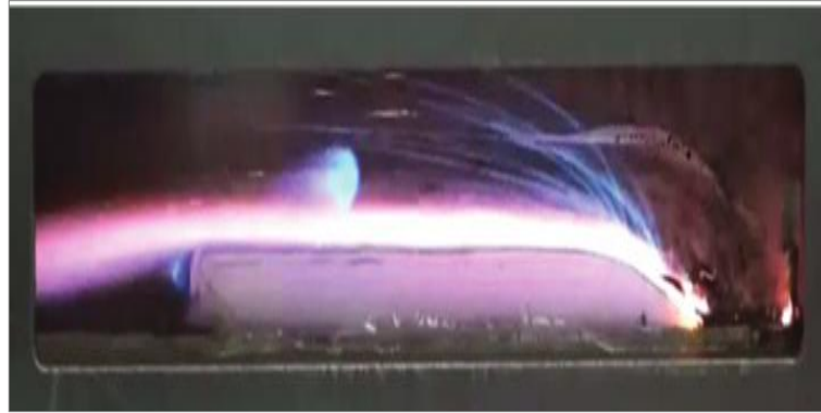
Figura 5. Fotografia da queima do combustível a base de parafina com oxigênio. Fonte: Nakagawa (2011)
