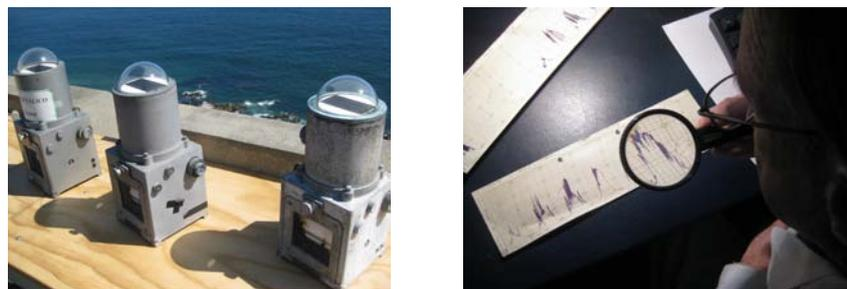
Figura 1 – Actinógrafos del ANS (izquierda) y el Sr. Robero Sotta (dercha) de la UTFSM, revisando mediciones.
