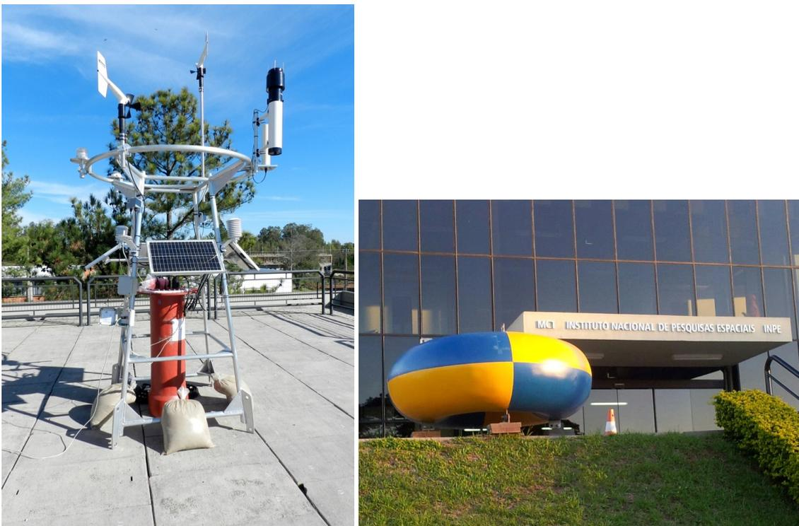
Figura 2- Boia meteo-oceanográfica que será instalada na Ilha Deception, Antártica. Esq. Torre com sensores integrados. Dir. Toróide onde será fixada a torre.
