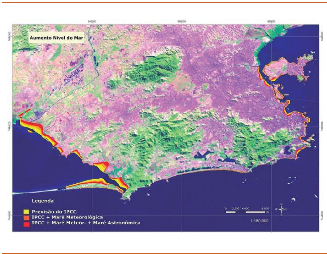
Figura 7.19 Identificação das áreas afetadas pelo aumento do nível do mar. O mapa indica, em laranja claro, as áreas com cotas até 0,40m; em laranja escuro, aquelas com cotas entre 0,40m e 0,60m; e, em marrom, as áreas com cotas de 0,60m até 1,50m. Esta última representa as possíveis áreas atingidas pela elevação do nível do mar, considerando as oscilações da maré, que podem alcançar 0,80m. Deve-se notar que o quantitativo das áreas atingidas é cumulativo, isto é, a cota até 1,50m inclui a cota até 0,40m e 0,60m, assim como a cota até 0,60m inclui a cota até 0,40m. Fonte: IPP (2008).
