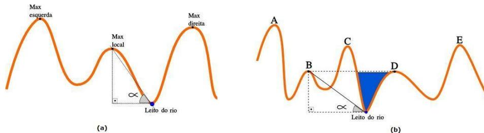
**Figura 1. (a) A seleção do ponto baseado na sua inclinação (b) O máximo local C irá impossibilitar a construção da barragem ligando os pontos B e D. Logo, não é possível selecionar o B para teste em relação à inclinação.**
