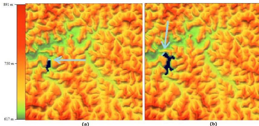
**Figura 4.** A parte mais escura da figura representa a área alagada devido a construção de uma barragem. (a) O volume do reservatório gerado é 1.012.500 m<sup>3</sup>. (b) O volume do reservatório gerado é 5.078.700 m<sup>3</sup>.
