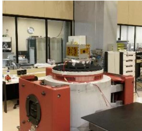
Figura 9: Shaker para teste de vibração (LIT/INPE)
