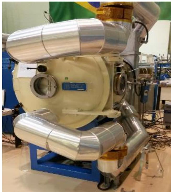
**Figura 5:** Câmara termo-vácuo (LIT/INPE)
