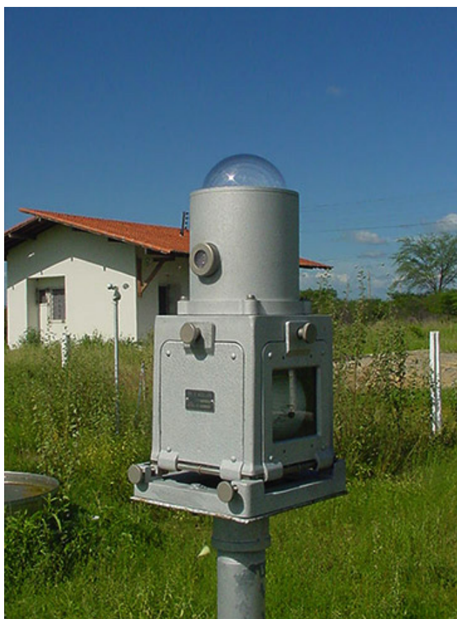
FIGURA 4.2 - ACTINÓGRAFO EM OPERAÇÃO NAS INSTALAÇÕES DO INPE FONTE: Os autores (2018).
