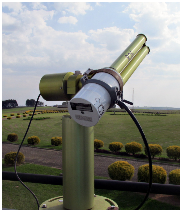
FIGURA 4.13 - FOTÔMETRO SOLAR INSTALADO JUNTO A ESTAÇÃO SONDA DO INPE, EM SÃO MARTINHO DA SERRA, RS
