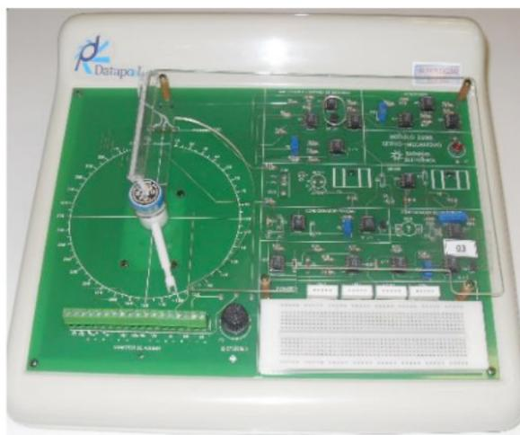
Figura 1 – Módulo Didático Datapool Servomecanismo
