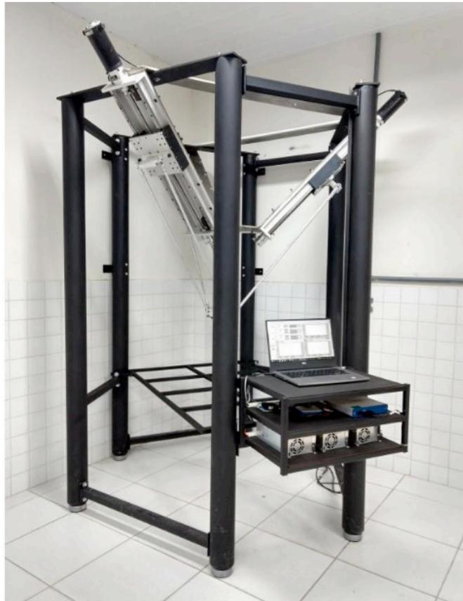
Figura 2. Mecanismo do robô paralelo proposto.
