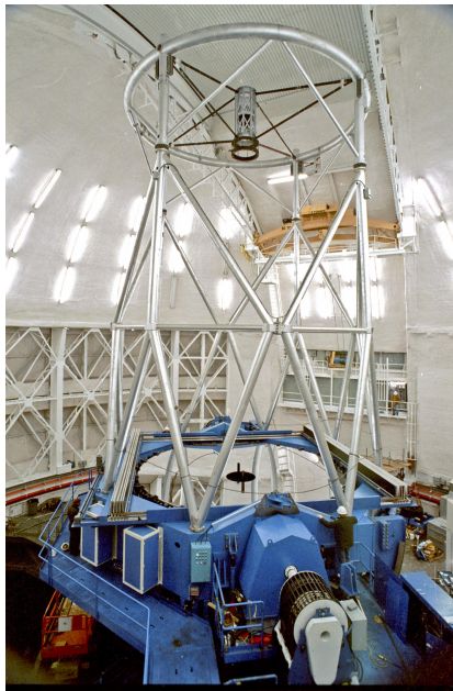
Figura 32 – O telescópio Gemini Sul, de 8 m de diâmetro, no Cerro Pachon, 2720 m de altitude. (Fonte: https://www.gemini.edu/gallery/media/whole-telescope ).
