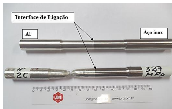
Figura 2. Foto do corpo de prova nº 2, antes e após a realização de ensaios de tração mostrando a fratura no lado da liga de alumínio com 327 MPa.
