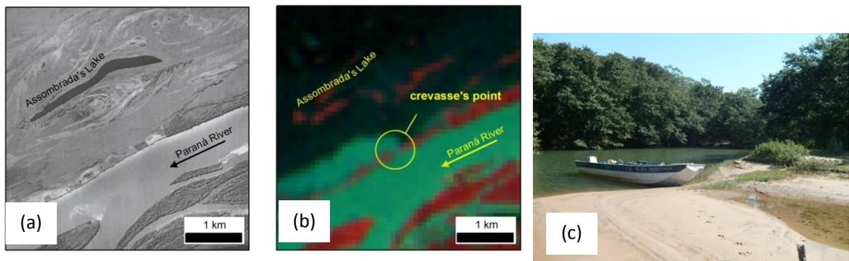
Figura 3. Surgimento da feição 1 entre os anos de 1970 e 1977. (a) fotografia aérea de 1970; (b) imagem LANDSAT-MSS R6G5B4 de 24/01/1977, em evento de cheia (6,70 m); (c) Foto em campo de 1/8/2007, mostra em detalhe a feição 1, com um canal bem desenvolvido e outro adjacente mais curto (cota: 3,00 m).
