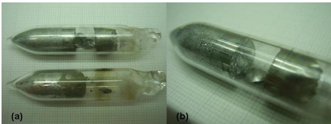
Figura 7 – (a) Amostras de PbTe (acima) e PbSn solidificadas em ambiente de microgravidade; (b) Detalhe da ampola com amostra de PbTe.
