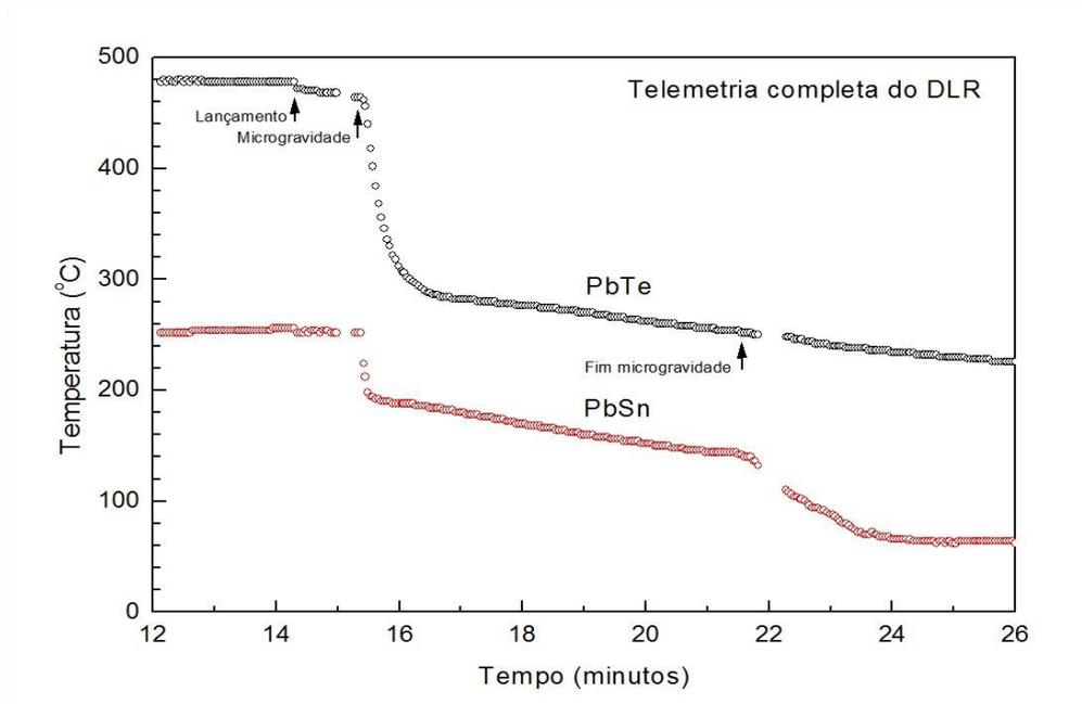
Figura 5 – Temperaturas dos termopares das amostras obtidos por telemetria.
