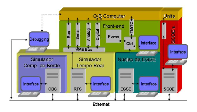
Figura 1. Ambiente de simulação configurado por módulos e interligado por rede ethernet. Adaptado de Hendricks e Eickhoff, 2005.
