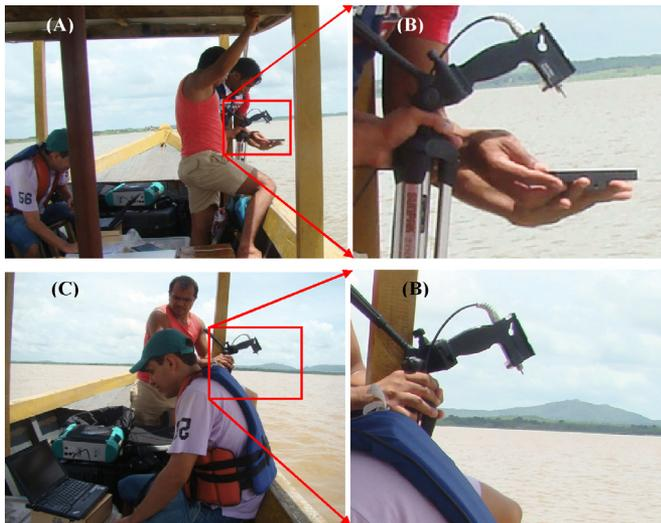
**Figura 2.** Leitura da placa lambertiana (A), zoom da leitura da placa (B), leitura da radiância espectral do sistema aquático (C), zoom da leitura da radiância espectral do sistema aquático (D) procedimentos realizados para a coleta de dados radiométricos no reservatório Orós, Ceará
