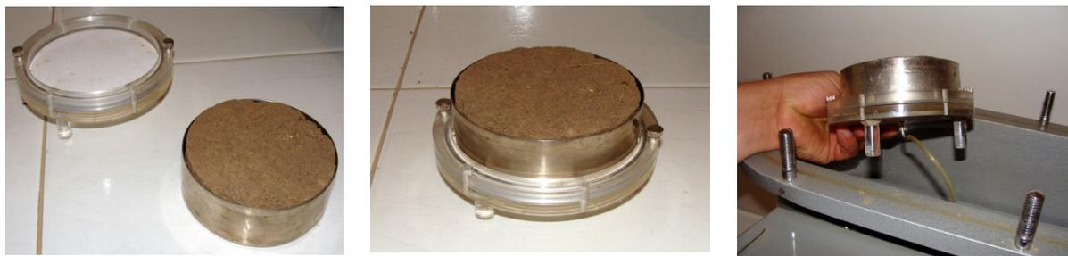
**Figura 3.** Anel volumétrico e dispositivo porta-filtro conectados ao sistema de drenagem do equipamento Multi-Fold pF Meter.
