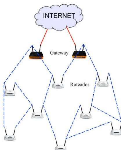
Figura 1 – Uma rede sem fio em malha
