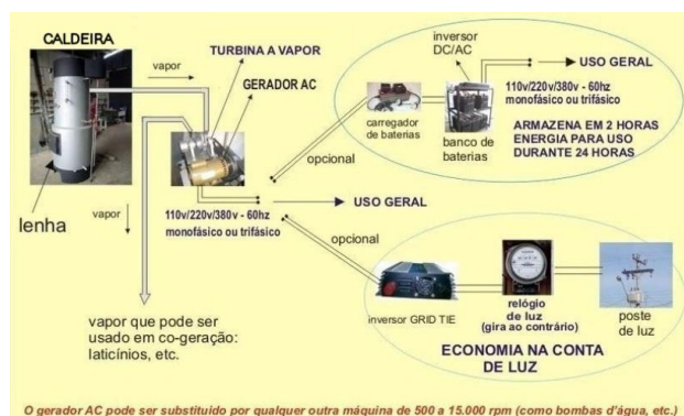
Figura 6: Esquema de utilização da turbina
