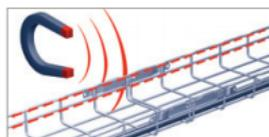
Conecte as partes metálicas à rede de aterramento (a cada 15-20 metros).
