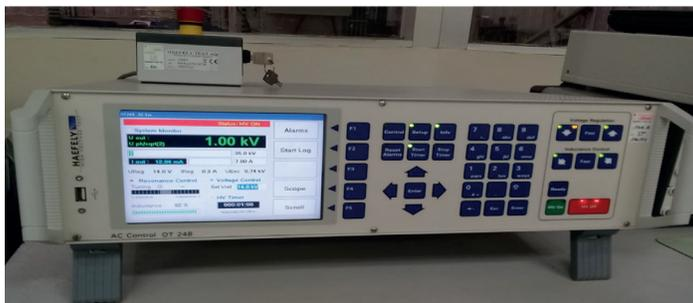
Fig. 4 – Terminal de Operação OT248 da Fonte Ressonante.
