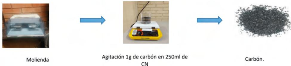
Figura 2 Adsorción de cianuro con carbón.
