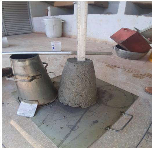
Figura 10: Concreto saturado com abatimento de 4,25 cm
