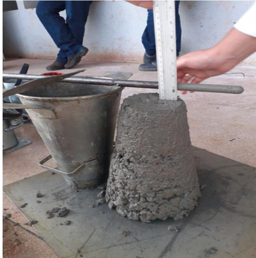
Figura 9: Concreto insaturado com abatimento de 2 cm
