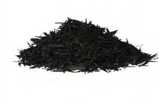
Figura 7: Borracha de pneu reciclada
