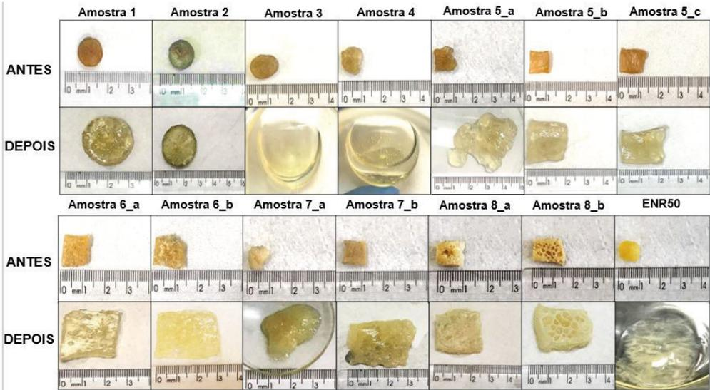
Figura 5. Teste de Inchamento das amostras de ENR50
