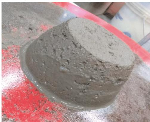
**Figura 1** - Ensaio de Índice de Consistência
