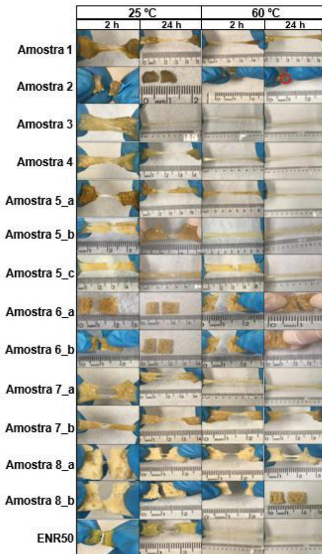
Figura 6. Ensaio de Autorreparação das amostras de ENR50
