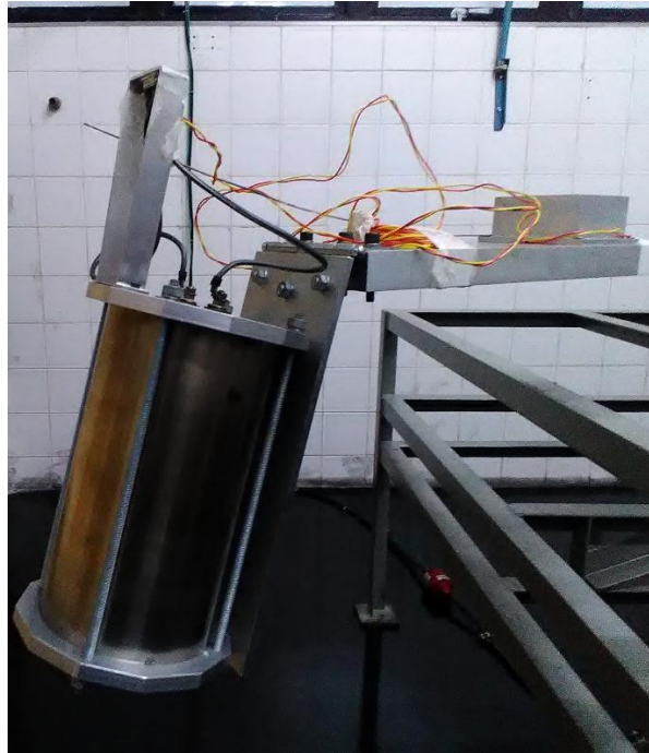
Figura 8. Fixação do forno no braço para ensaios com altas acelerações.
