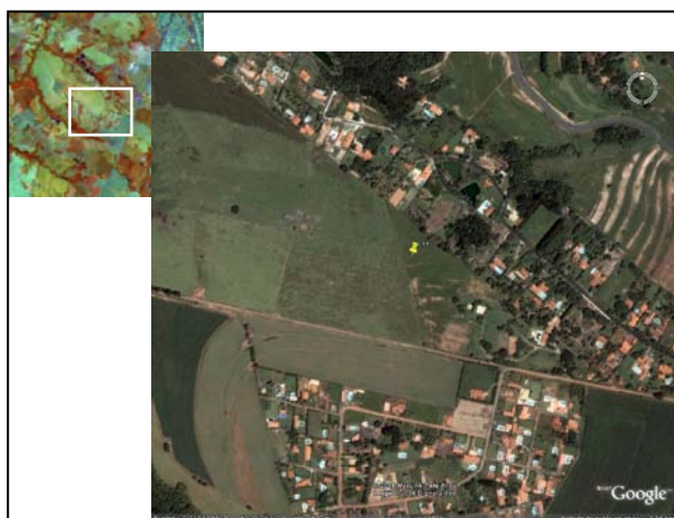
Fig. 6 – Exemplo de área urbanizada, destacada na imagem da alta resolução, que não foi classificada como urbana (erro de omissão)
