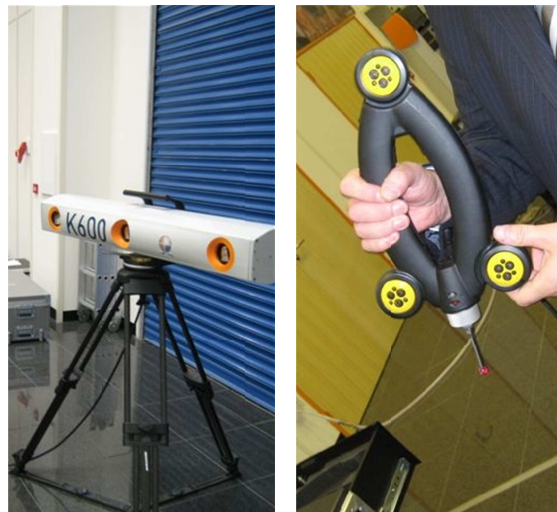
Figura 3: Sistema de medição por fotogrametria e apalpador.
