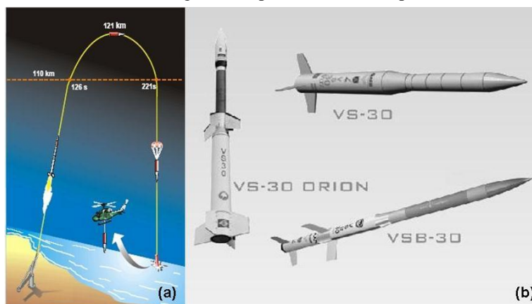
Figura 1 – (a) Esquema de um voo parabólico do VS-30; (b) Foguetes de sondagem brasileiros para microgravidade.
