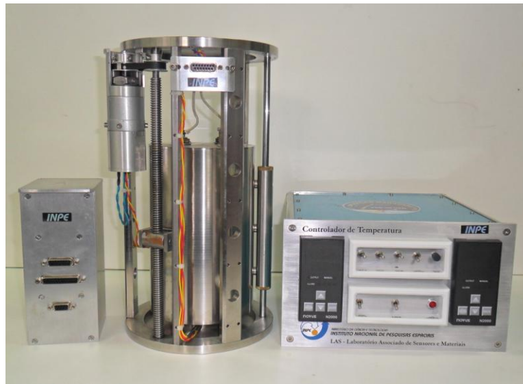
Figura 2 – Forno de solidificação com o módulo eletrônico e controlador de temperatura.
