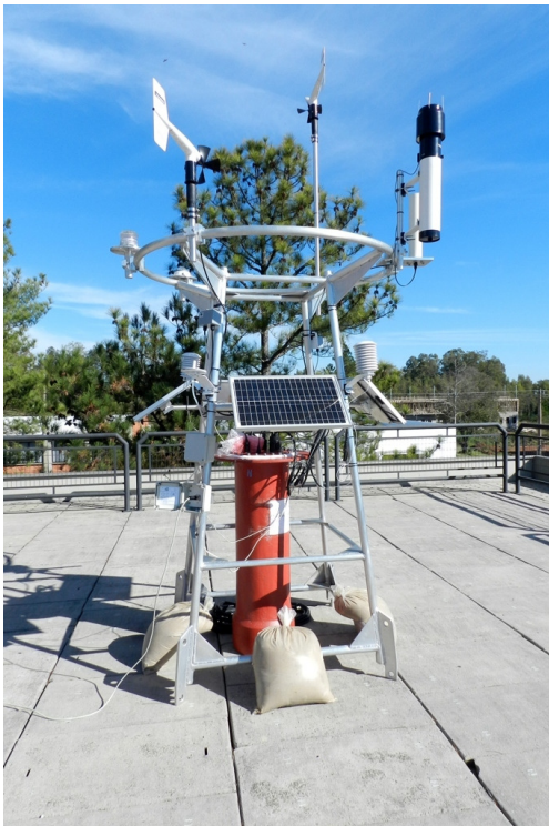
Figura 2- Boia meteo-oceanográfica que será instalada na Ilha Deception, Antártica. Esq. Torre com sensores integrados. Dir. Toróide onde será fixada a torre.
