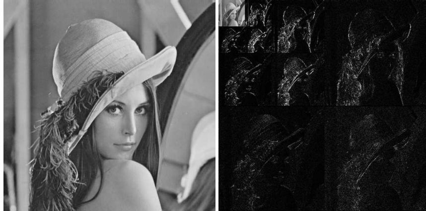
Figura 5.1: Imagem original (esquerda) e sua decomposição em 3 níveis aplicando-se o módulo e um ganho.
