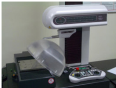
Fig. 4. Configuração de medição de rugosidade na máquina de medir rugosidade de superfícies complexas
