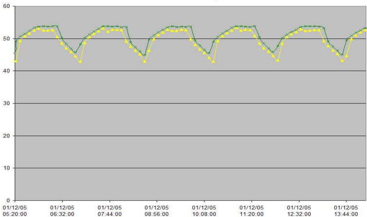
Figura 2 – Dados da telemetria de tensão da bateria do satélite CBERS2. Eixo vertical é tensão da bateria em Volts. Eixo horizontal é tempo.
