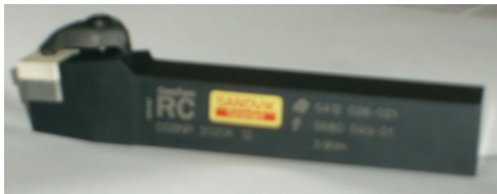
Figura 3- Geometria da ferramenta; Figura 4- Porta ferramentas modelo DSBNR 2020K 12
