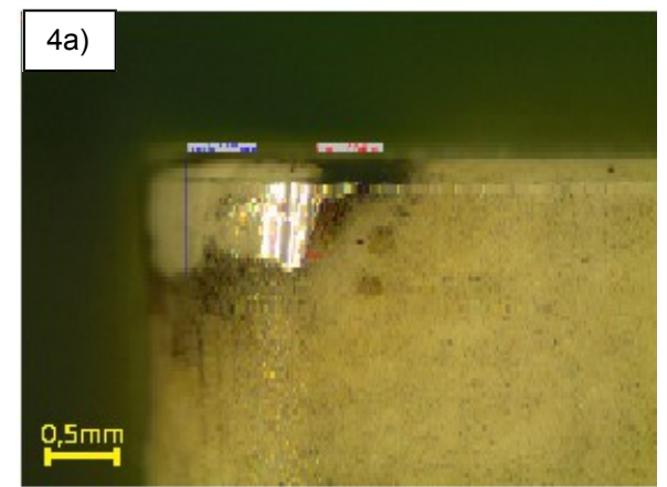
Figura 10- Desgaste de flanco da V_c=500\text{m/min} , f=0,25\text{ mm/rot} ; Figura 11- Desgaste de flanco da V_c=500\text{m/min} , f=0,10\text{ mm/rot} ;
