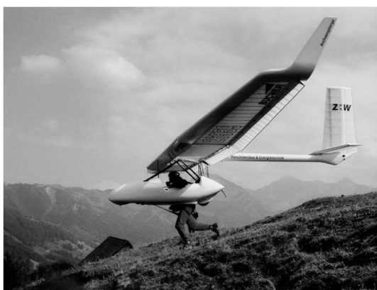
Figura 1 - Exemplo de um planador foot-launched . FONTE: Question Gravity (2014).
