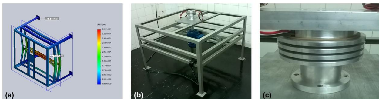
Figura 1. (a) Simulação no SolidWorks ; (b) Centrífuga; e (c) Contato elétrico rotativo.
