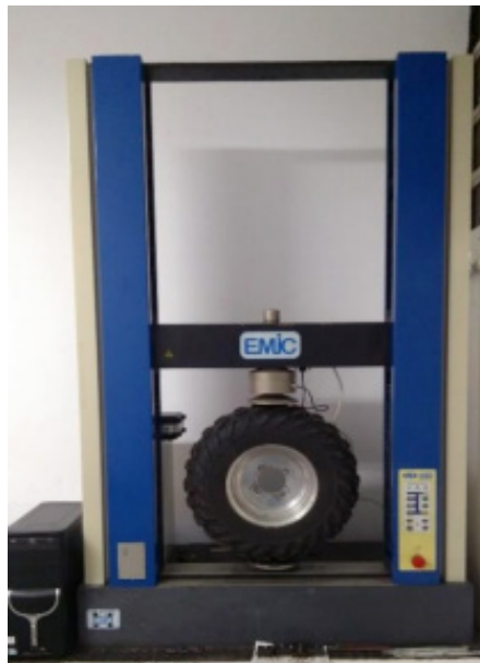
Figura 7 – Realização do teste de compressão
