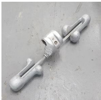
FIGURA 2. Stockbridge assimétrico utilizado nos ensaios.
