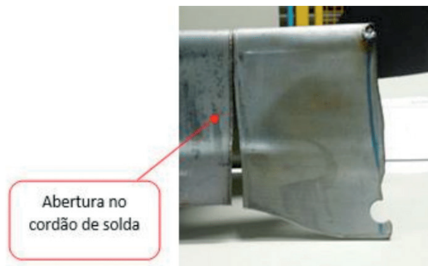
Figura 1 – Peça estampada fora dos padrões de soldagem.
