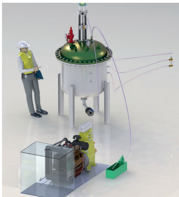
Figura 2 – Leiaute da bancada inserida no sistema total
