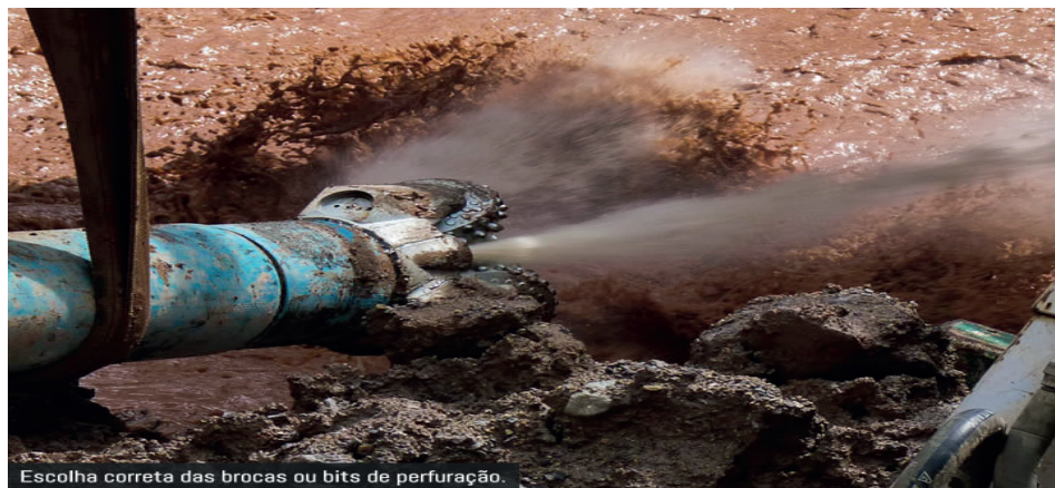
Figura 6 – Detalhe da broca de perfuração.
