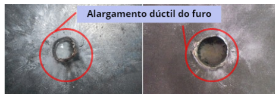
Figura 20: placas de aço dos módulos perfuradas.
