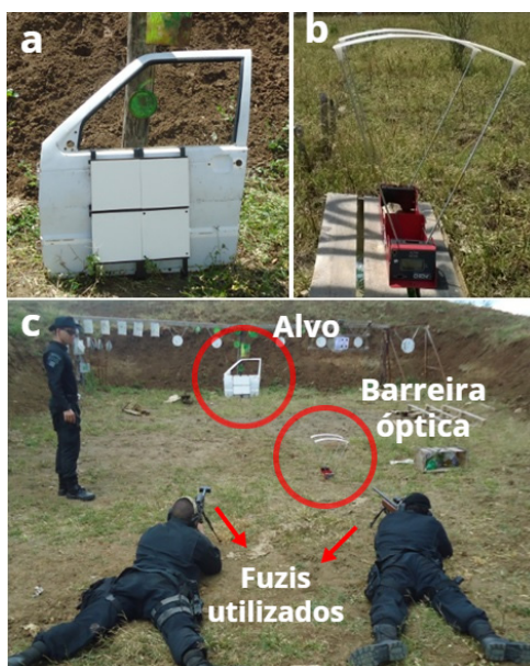
Figura 18: (a) estrutura pronta para o ensaio balístico; (b) cronógrafo balístico Shooting Chrony; (c) realização dos testes balísticos.
