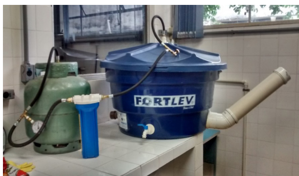
Figura 6 – Biodigestor construído com caixa d'água de 150 L e materiais disponíveis no mercado.
