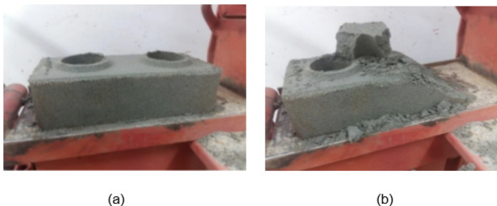
Figura 4 - Bloco com 100% de resíduo (a) antes do manuseio (b) após a tentativa de manuseio
