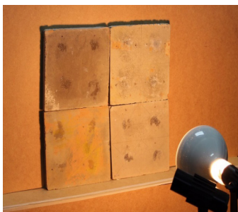
Figura 2 – Ensaio de Análise Termográfica
