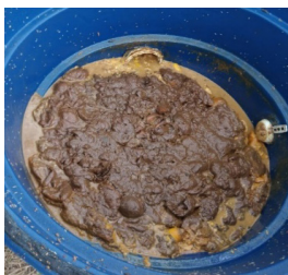
Figura 8 – Aspecto dos resíduos alimentícios após oito semanas no biodigestor.
