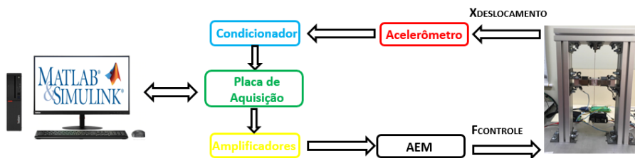
Figura 7. Modelo esquemático de controle.
