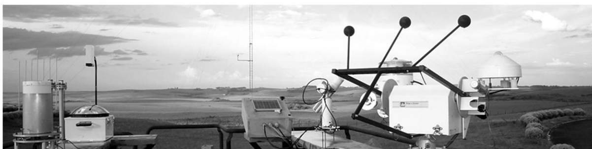
Figura 2 – Foto da estação de coleta de dados solarimétricos e anemométricos de referência (torre anemométrica ao fundo) localizada em São Martinho da Serra.
