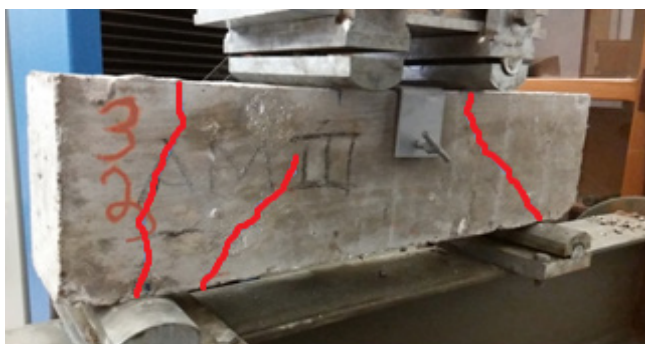
Figura 26 – V03–C fissuras após o ensaio.
