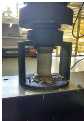
Figura 10 - Ensaio de resistência à compressão axial dos copos de prova.
