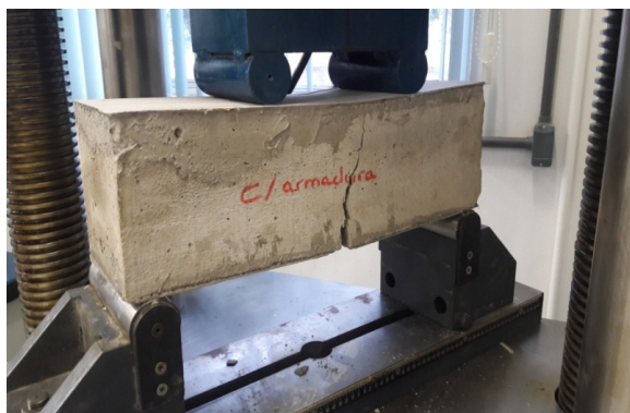
Figura 5: Propagação da fissura através do entalhe (Autor)
