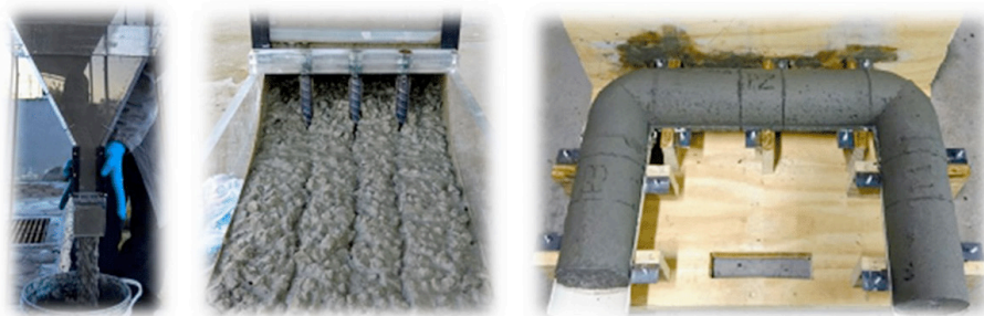
Figura 3 - Ensaio para o funil V (Fluidez ideal), caixa L (Princípio de segregação) e tubo U.
