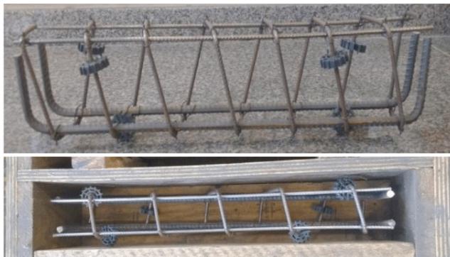
Figura 10 – Armadura V04 com estribos contínuos com \varnothing 5,0 mm e espaçamento de 7,5 cm (= a V03).
