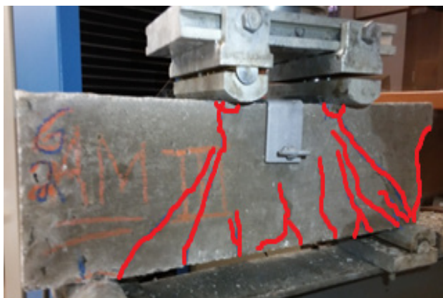
Figura 37 – V06–B fissuras após o ensaio.
