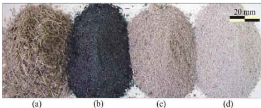
Figura 2 – (a) Bagaço da cana-de-açúcar; (b) Cinza escura com alto teor de carbono; (c) Cinza com menor teor de carbono; (d) cinza gerada após a combustão completa, teor de carbono inexistente ou muito baixo.
