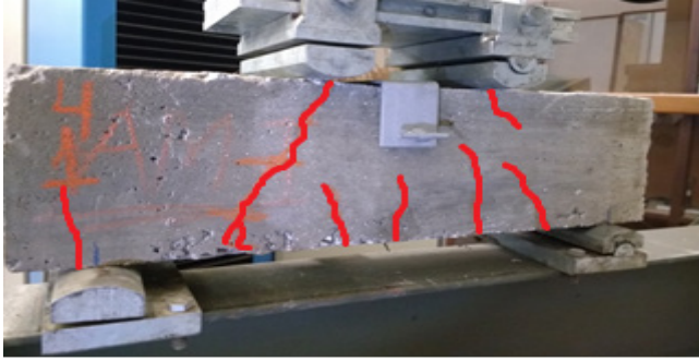
Figura 28 –V04– fissuras após o ensaio.
