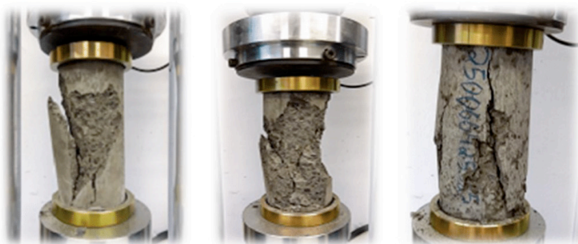
Figura 4 - Corpos-de-prova do CAA após o ensaio de resistência mecânica.
