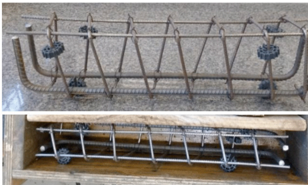
Figura 9 – Armadura V03 com estribos contínuos com Ø 5,0 mm e espaçamento de 7,5 cm.
