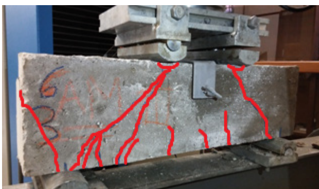
Figura 38 – V06–C fissuras após o ensaio.
