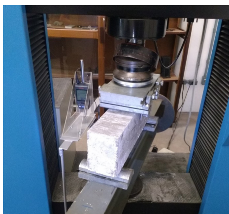
Figura 13 – Ensaio da viga vista frontal.
