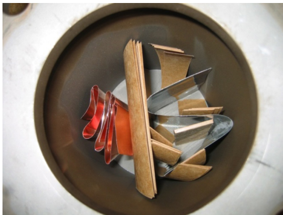
Figura 1 - Célula de envelhecimento contendo os materiais sólidos.
