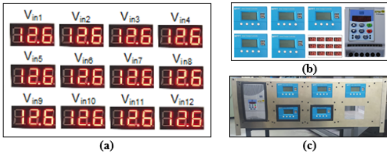
Figura 9 – Painel de Controle e Monitoração – (a) Disposição dos Displays – (b) Lay Out – (c) Parcialmente montado
