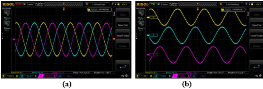
Figura 13 – Formato de onda da saída do inversor – (a) Fase R em amarelo, fase S em azul claro e fase T em roxo – (b) As três fases separadas
