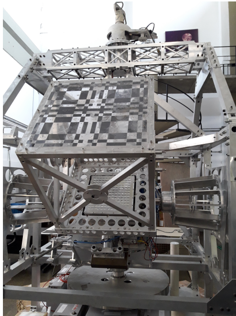
Figura 29 – O telescópio ProtoMirax para raios X, com o padrão de aberturas na parte superior. (Fonte: Elaboração do autor).
