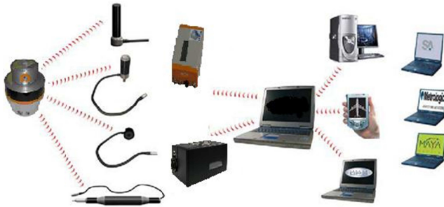
Figura 5: Visão geral do iGPS (sensores, transmissores e receptores tipo Ethernet).
