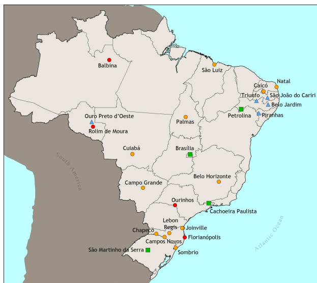
Figura 9 - Distribuição das estações de dados de superfície da rede SONDA no território brasileiro. Estações identificadas com forma quadrangular são estações de referência com equipamentos para aquisição de dados de energia solar e eólica. Maiores detalhes sobre a Rede SONDA podem ser obtidas em www.sonda.ccst.inpe.br .
