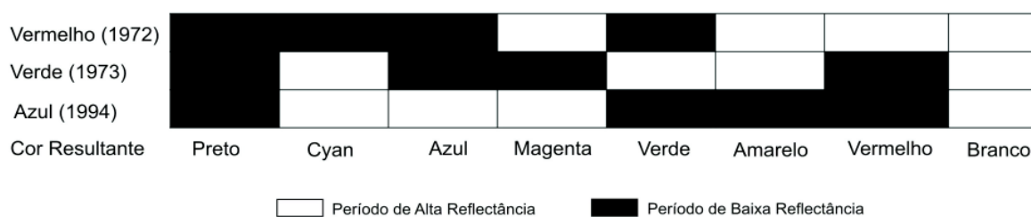
Figura 2 - Modelo simplificado da formação das cores na composição colorida multitemporal - CCMT (Adaptado de EYTON, 1983). Quando não ocorrem mudanças, as feições aparecem em tonalidades de cinza que variam do preto (baixa ou nula de refletância) ao branco (alta ou máxima refletância). As cores aparecem em função das diferenças de refletância em uma ou outra data.
