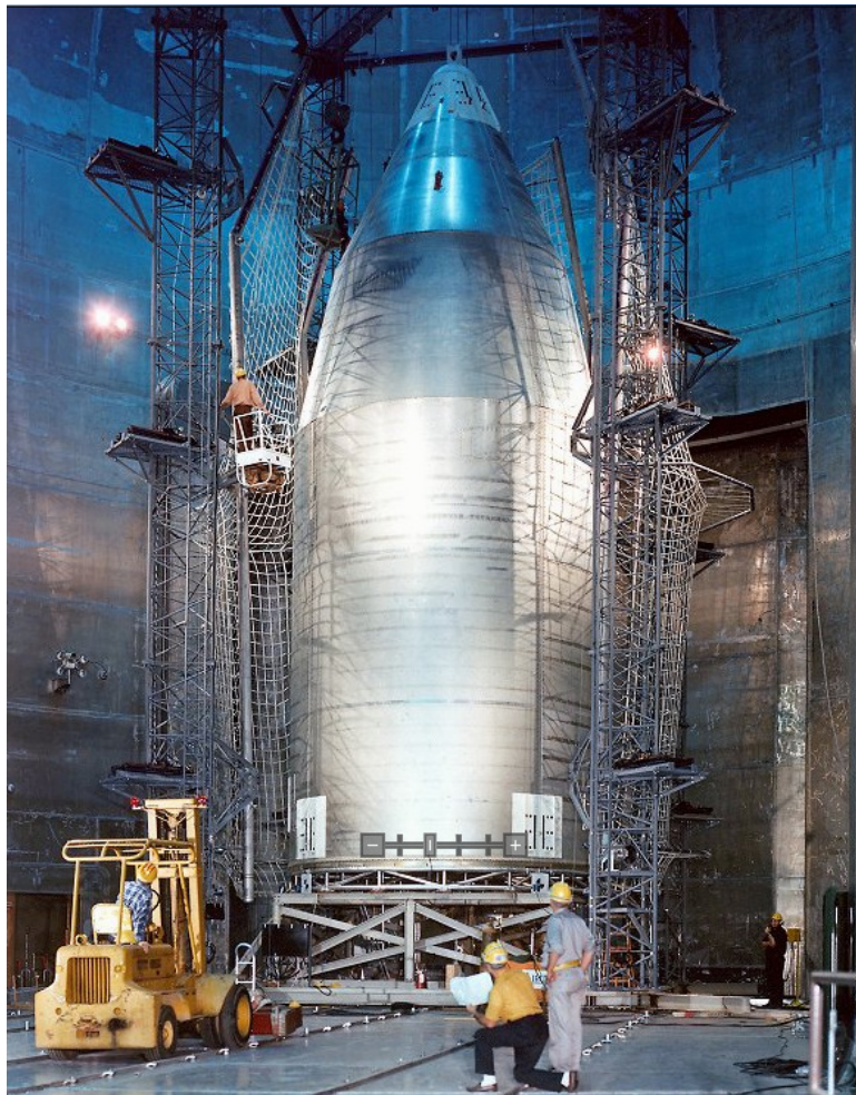
Figura 3 - Preparação para testes com o Skylab no SPF- Glenn Research Center Fonte: (GRIN, 1970)
