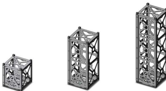
Figura 1. Cubesats do tipo 1U, 2U e 3U.
