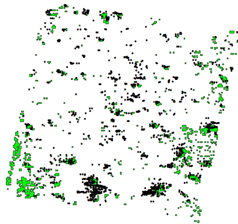
Figura 3: Comparação entre a área queimada identificada pelo algoritmo (verde) e os focos de calor (todos os satélites) da base de dados do INPE (preto).
